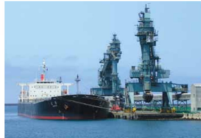
石炭船とアンローダー(石炭荷役機械)
